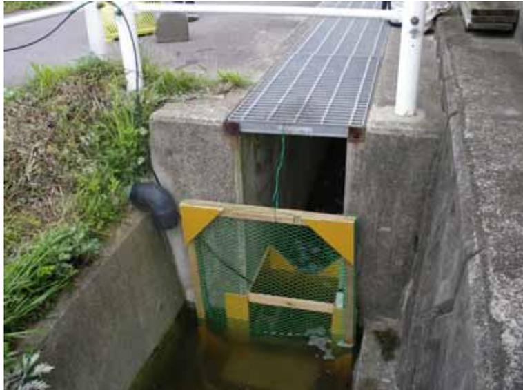
写真5-6 三角堰設置状況(実証池にて)
