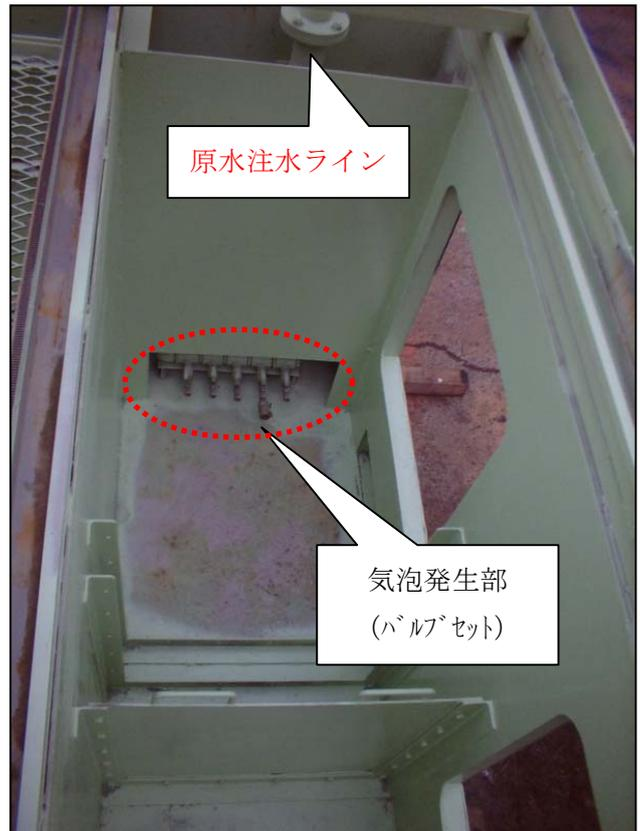
水槽内部構造(二次処理槽)
