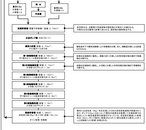
各槽を並列させることで短絡流を防ぐと同時に生物処理および物理化学処理をするための滞留時間を増やすこと、また稼動の効率性をあげることが期待できる。また、かき殻を接触ろ材として活用することで懸濁物質の吸着やpHコントロールの他、かき殻自体のリサイクルにも貢献できる。
