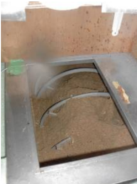
オガクズ攪拌槽内部
