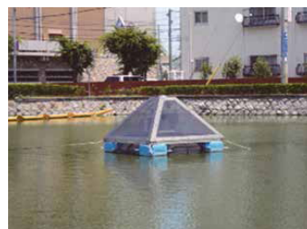
環境配慮型攪拌装置
