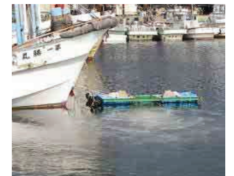
装置1設置状況(浮体吊り下げ式)
