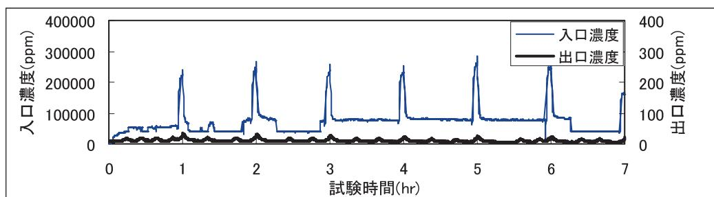
※本装置は1時間に1回5分間霜取りのためファンが停止する。入口濃度に見られるピークはそのため濃度上昇である。
