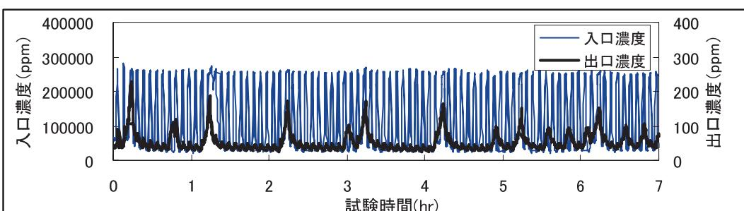
※本装置は1時間に1回5分間霜取りのためファンが停止する。出口濃度に見られるピークはそのため濃度上昇である。
