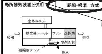
熱交換ユニット内のコイルがクーラーにより約-20℃に冷却され、装置内を冷却し吸引ガス中の溶剤を凝縮させる。吸引ガスの冷却温度は処理風量により異なるが、約5℃～15℃である。凝縮されないガスは活性炭に吸着させる。
