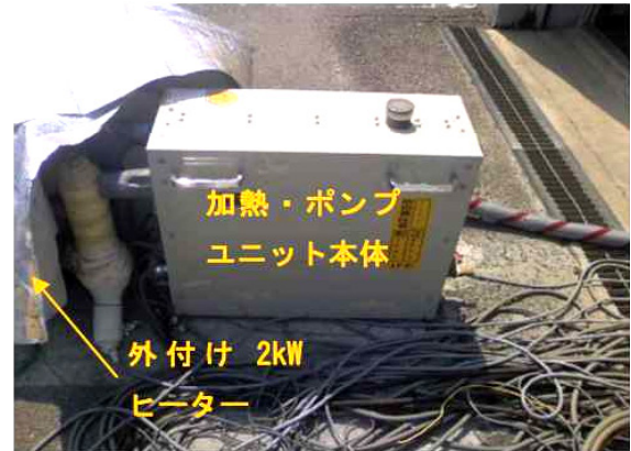
加熱・ポンプユニットの写真
