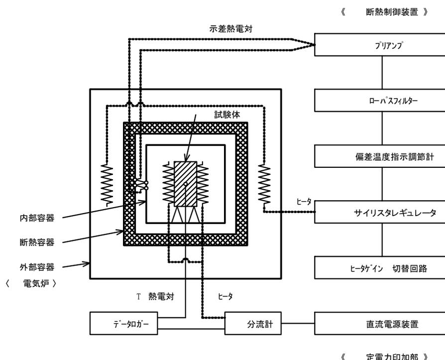
図3 断熱熱量計比熱測定装置概要
