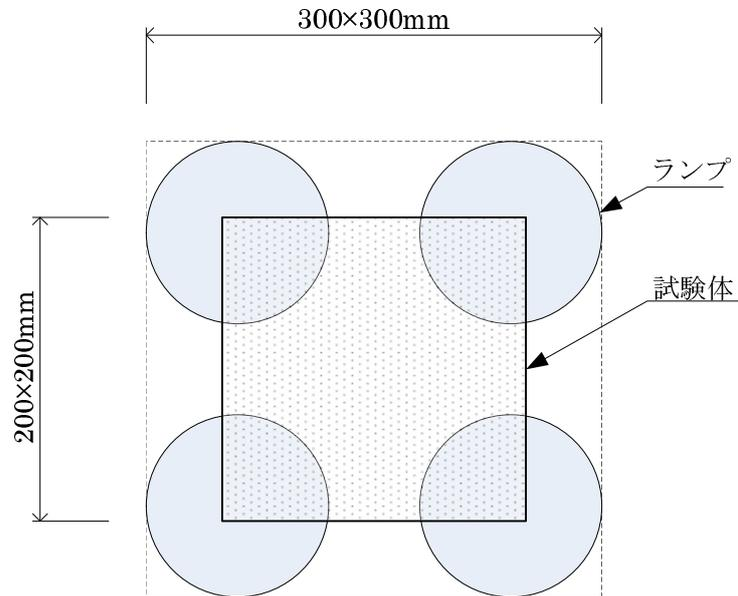
図2 ランプと試験体の位置
