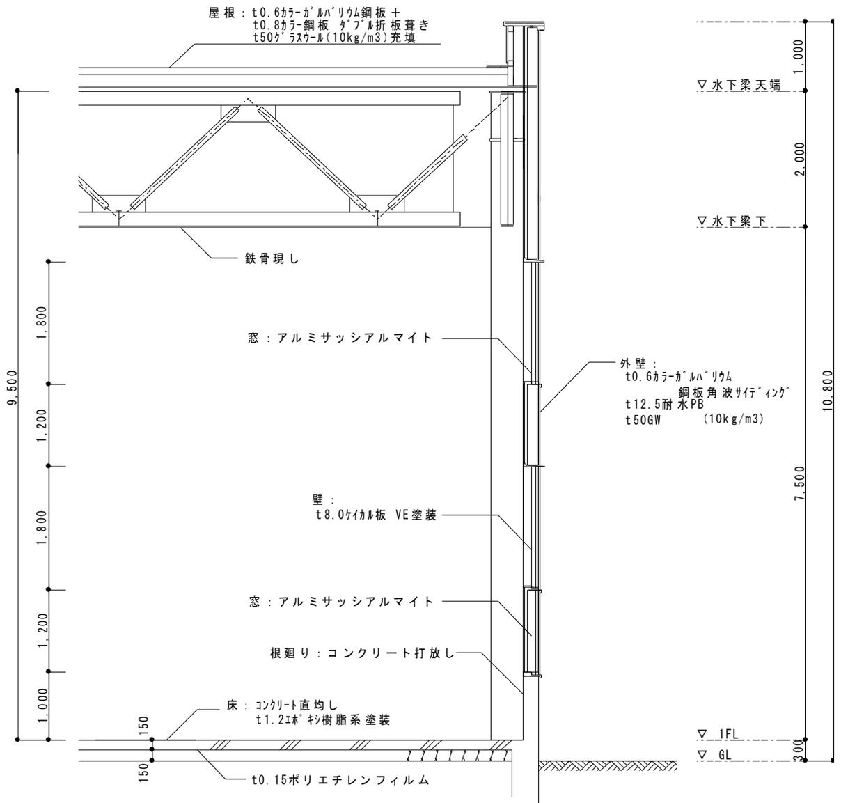
図 11 計算用工場モデル (矩計図)
