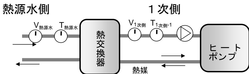
図 11 交換器における測定点
