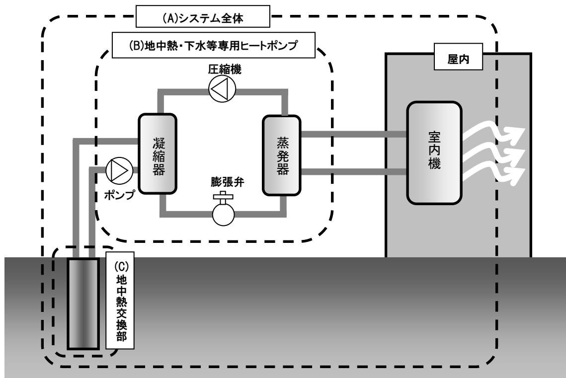
図 2 地中熱・下水等を利用したヒートポンプ空調システム<sup>4</sup>
