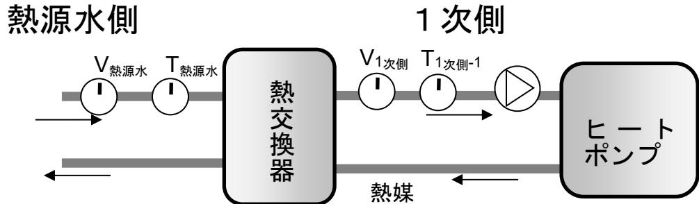
図 11 交換器における測定点
