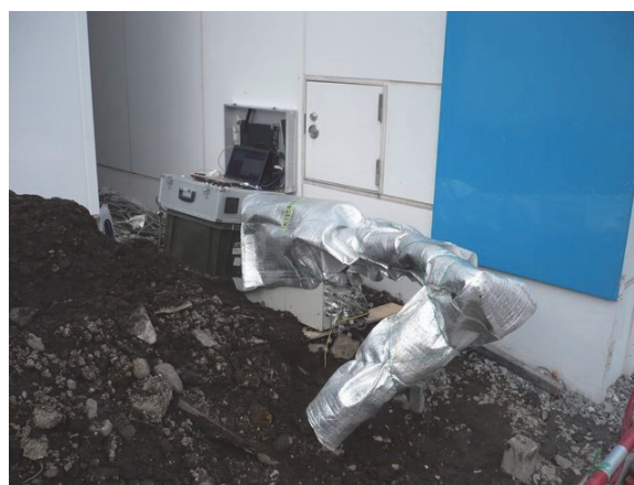
写真6 保温材の上を銀色シートを覆い、この状況で加熱循環試験を行った。
