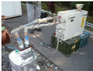
写真3 U字管と試験装置を接続した状況
