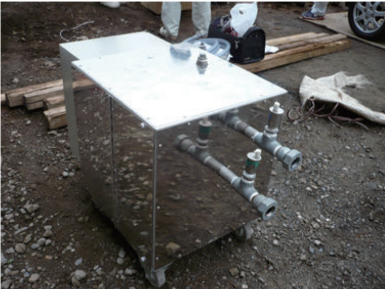
写真 3 サーマルレスポンス試験装置
