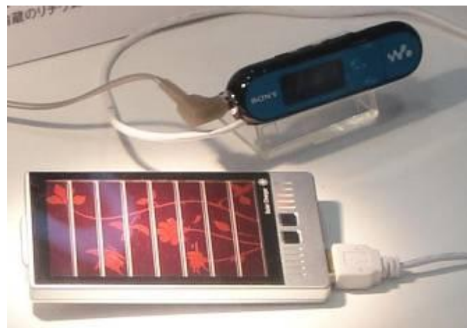
色素増感太陽電池／リチウムイオン電池ハイブリッドチャージャー試作機による“ウォークマン”再生デモ(2009年12月)
