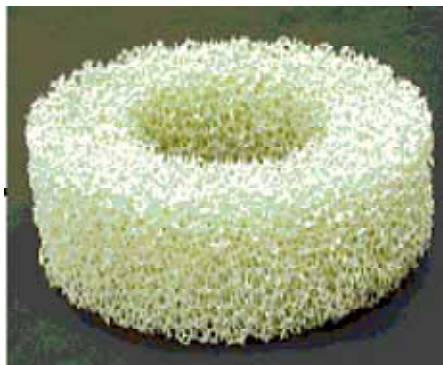
図3 三次元微細セル構造磁器質光触媒フィルター
