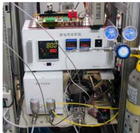
図5 簡易型希釈器の全景写真 表示のある上のが希釈器の制御部 バルブの付いた下のが希釈器本体 ここでは縦におかれている
