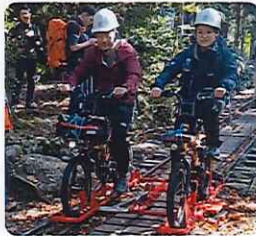
森林軌道を活用したレールバイクの実証試験 (資材等の運搬を目的とする)
