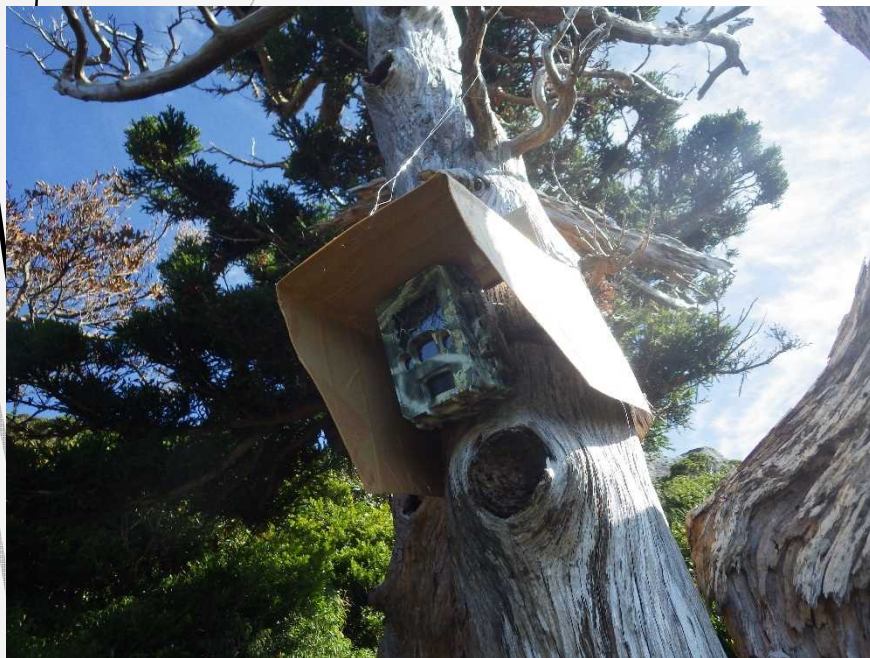
黒味岳に設置した自動撮影カメラ ・タイムラプス：1時間おきに撮影 ・囲いは雪よけのため
