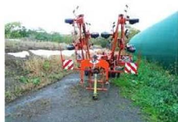
テッダは牧草の乾燥を促進させるための機械で、牧草の層を反転・拡散することで乾燥のムラを解消します。
