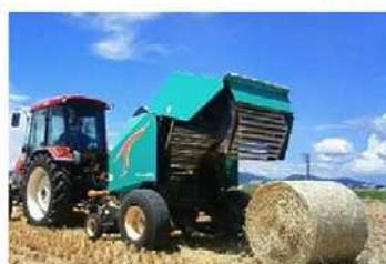
ロールベーラは牧草を拾い集めて直径約1.5mの円筒形ロールにするための作業機で、ローラを用いて成型する「ローラ式」とベルトを用いる「ベルト式」の2つのタイプがあります。
