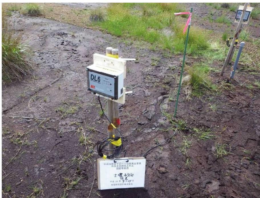
写真 V. 6.1 土壌水分計の設置状況
