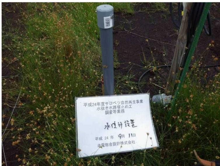
写真VI. 3. 1 水位計設置状況
