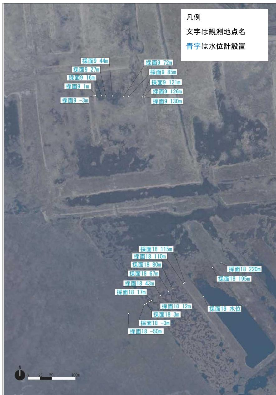
図VI. 5.40 泥炭採掘跡地観測孔位置図
