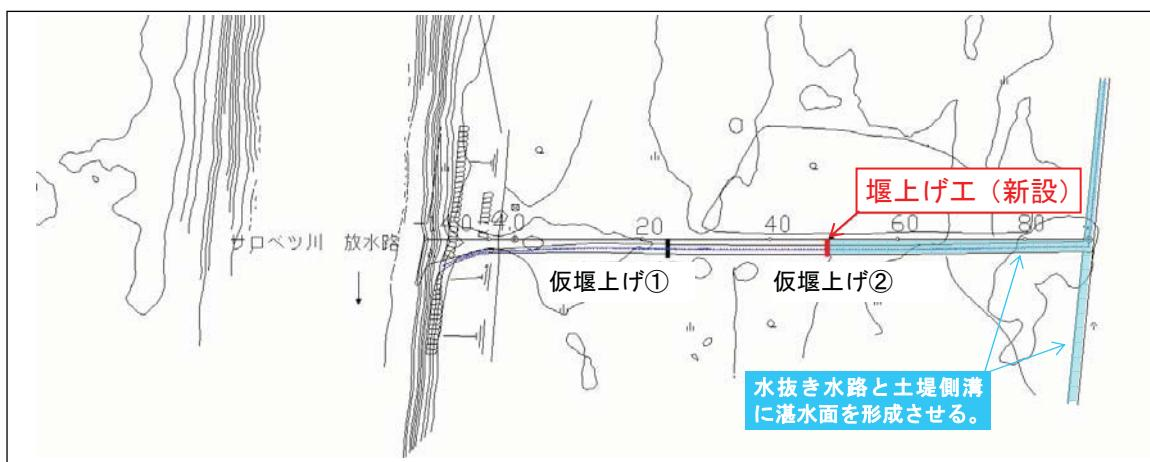
図 2.16 木材による堰上げ工 設置位置図
