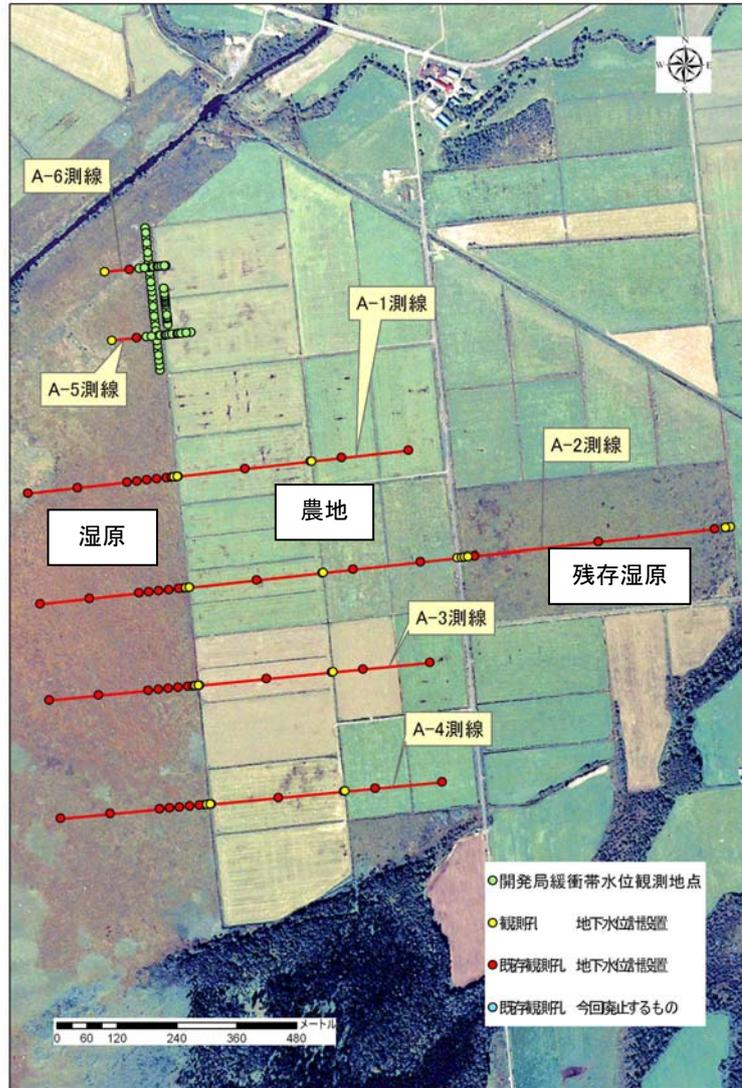
図 8.1 A測線の地下水位モニタリング位置図
