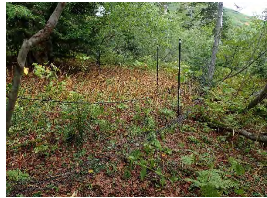
試験柵 A ネットの垂れ下がり
