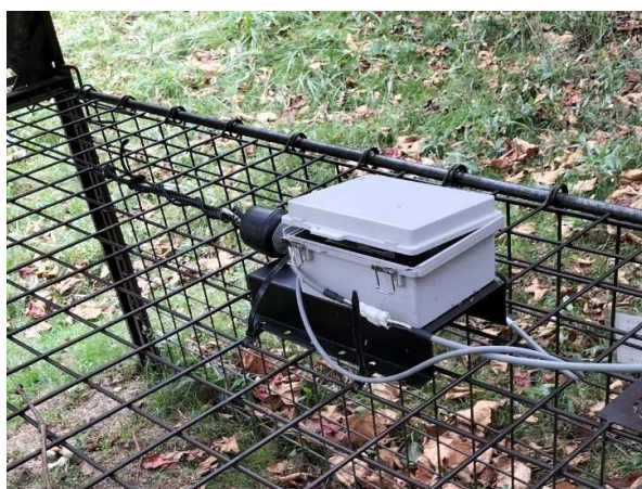
写真 3-2-3-10 トリガー部（電磁石）と制御ボックス
