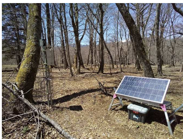
写真 3-2-3-7 電源供給部（ソーラーパネル）
