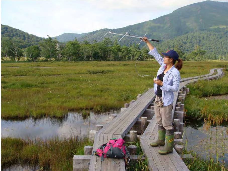
写真 3-8 わな用発信機の電波の方探
