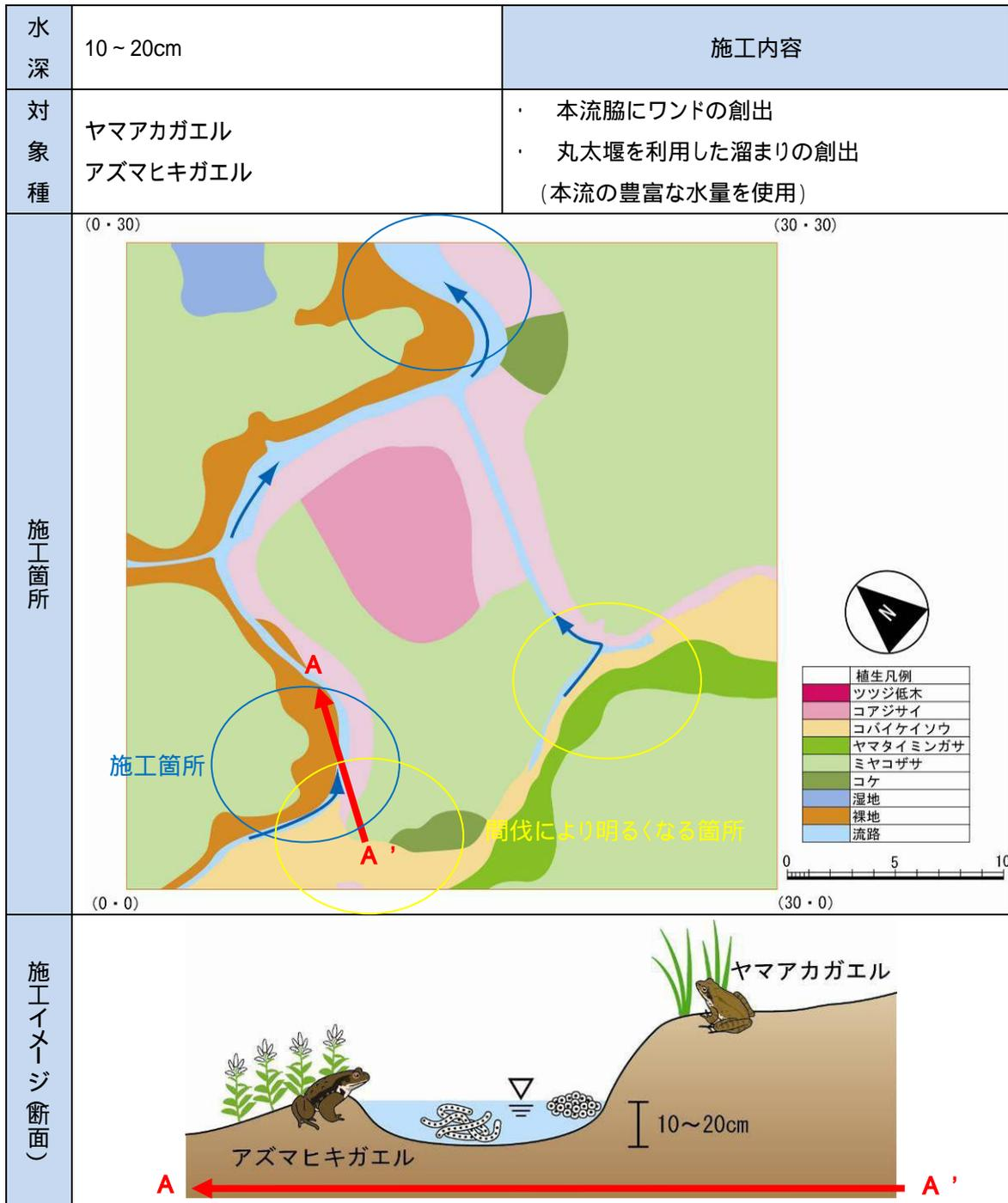
図 - 5-4 両生類の繁殖環境に配慮した施工（水辺群落）
