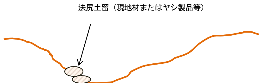
図. 土留の設置箇所
