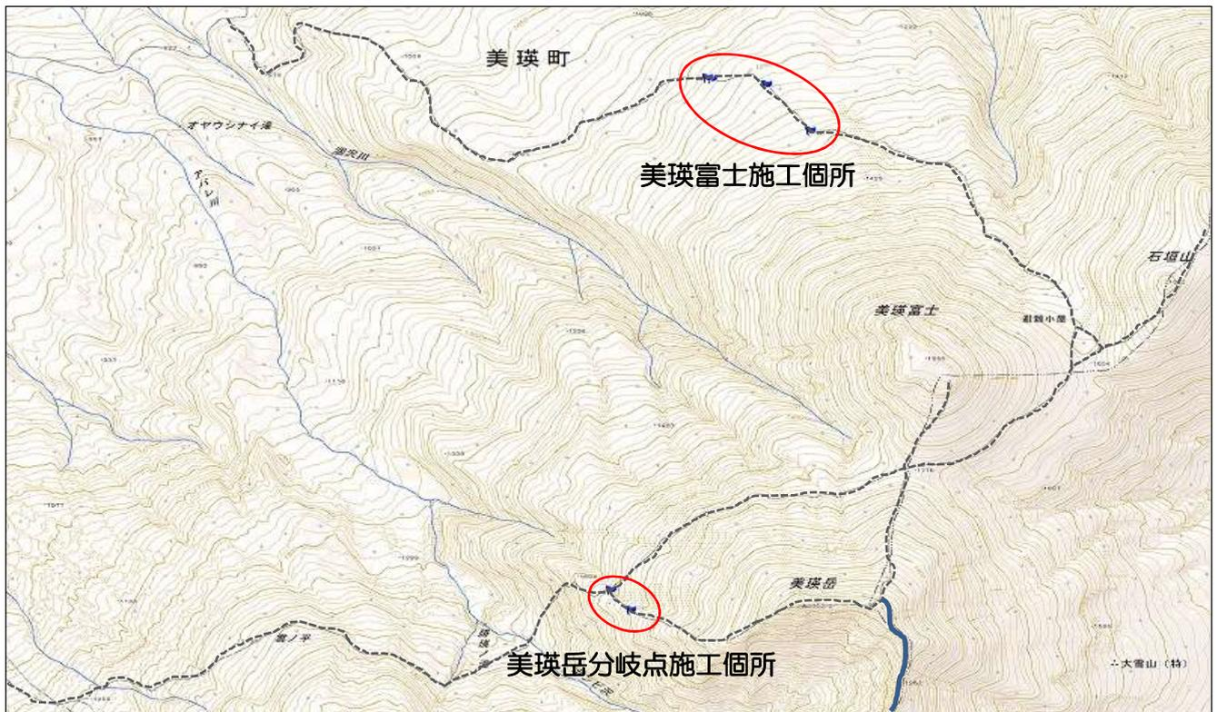
美瑛富士、美瑛岳に至る登山道は毎年登山道整備が行われてきたが、どちらの場所も流水や踏圧侵食などによりガリー化が進み、歩きにくさだけでなく地形変化が激しく、そのまま放置するとさらに大規模な侵食に拡大する恐れがあった。そのため平成26年からはその一部（上記位置図）において近自然工法による登山道整備が試されている。
