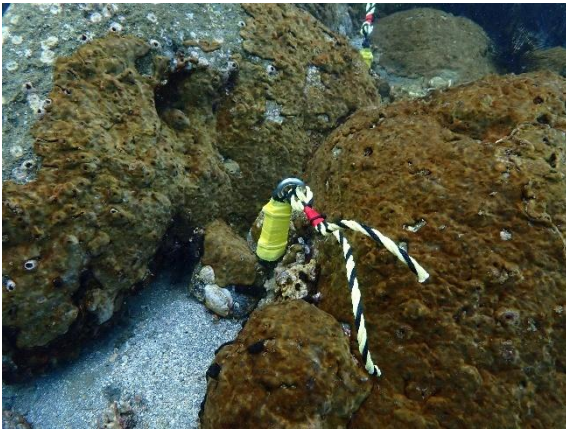
図 3-4-2(3) モニタリングサイト 1000 地点の水温ロガー交換前後の状況(令和 8 年 1 月)
