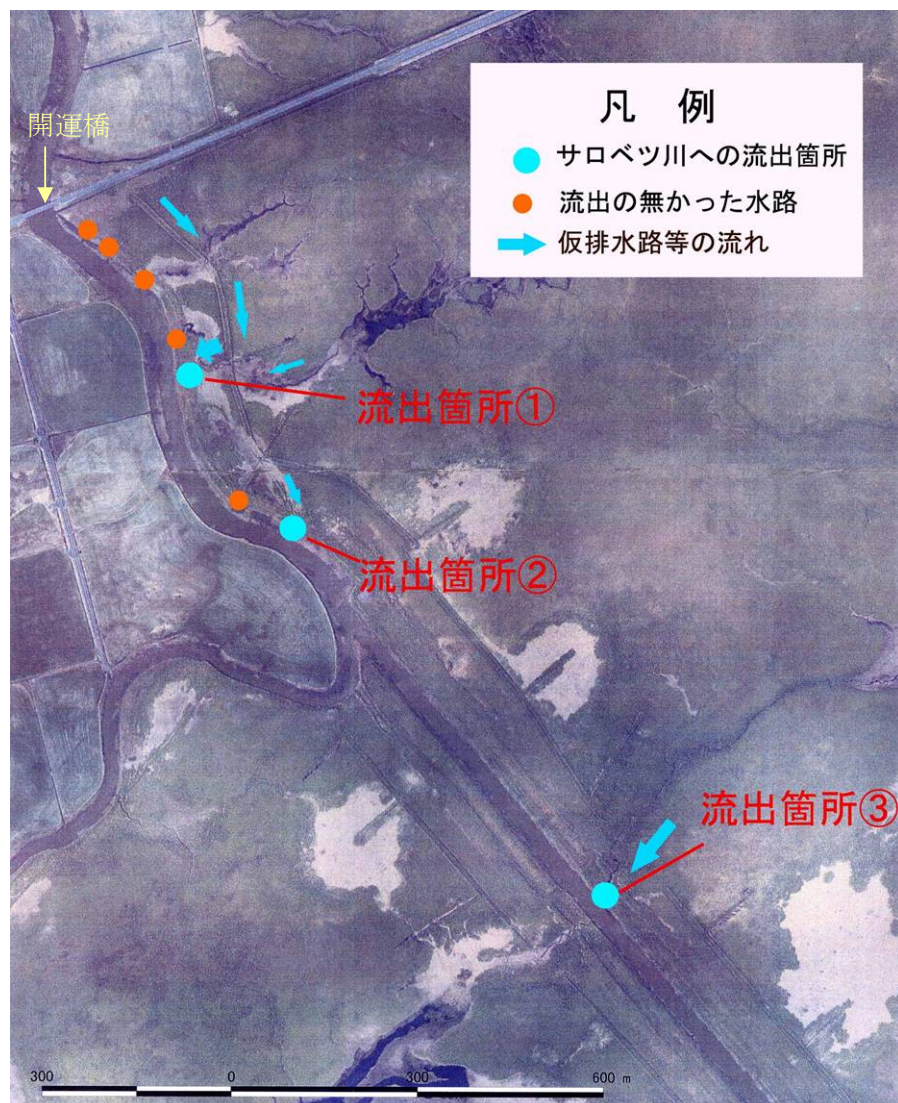
図 5.2.13 仮排水路等の流出箇所調査結果
