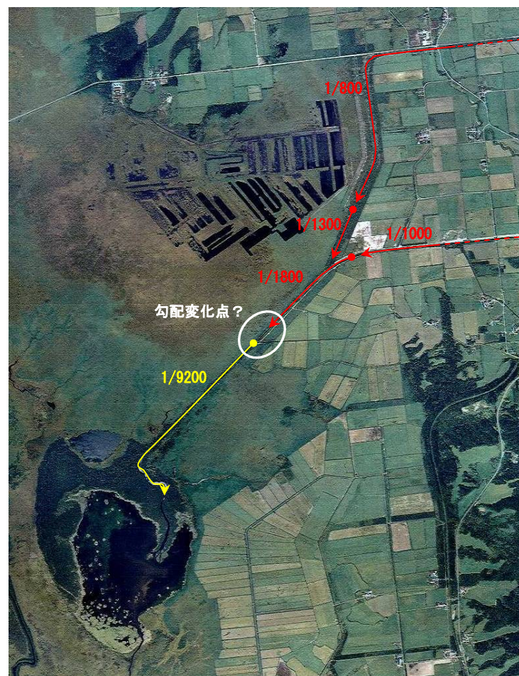
図 9. 2. 4 推測される縦断勾配の変化
