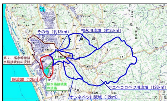
図 9.1.7 ペンケ沼の流域面積の変化
