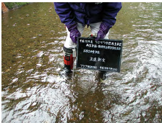
写真 8.1.3 流速計による流速測定状況
