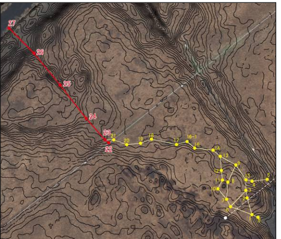
測線位置図 (水抜き水路)
