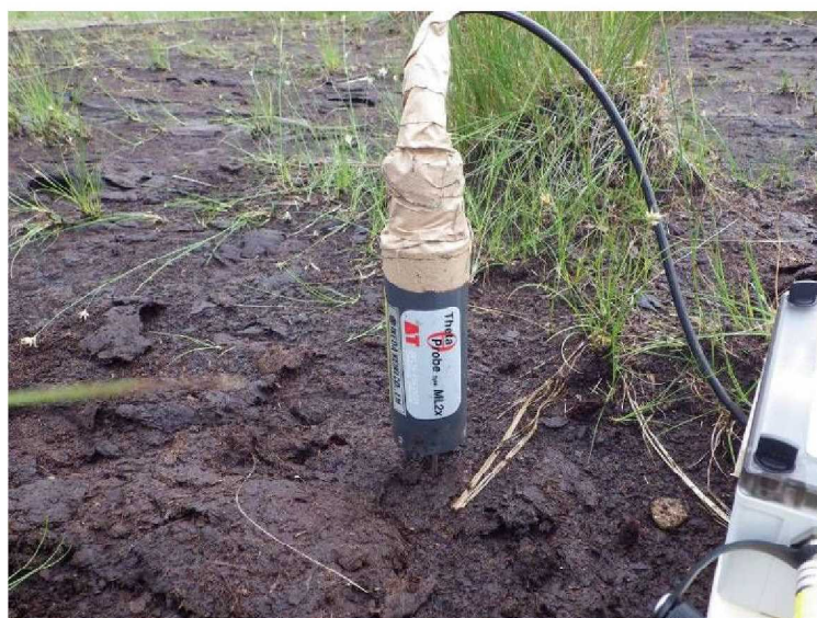
写真 V. 6. 2 土壌水分の計測状況
