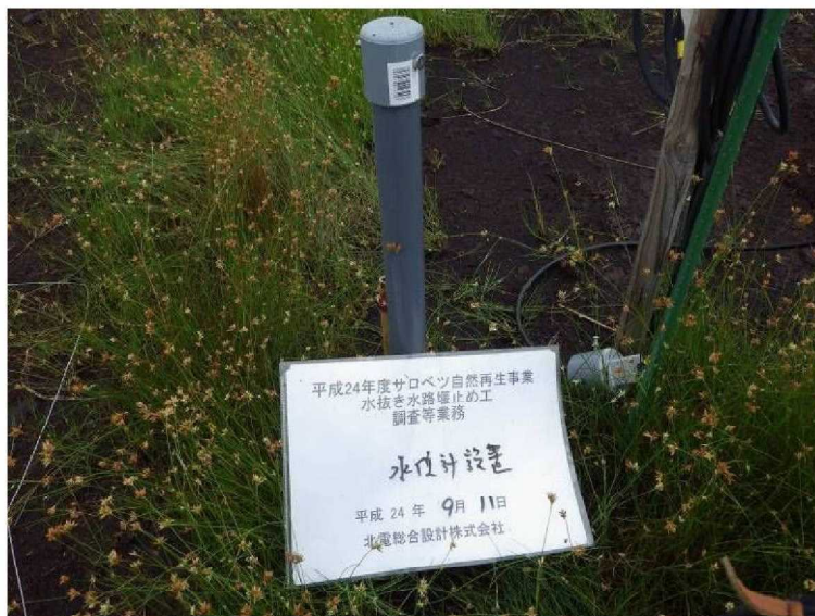
写真Ⅵ. 3. 1 水位計設置状況
