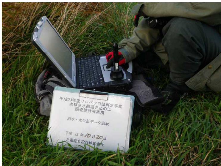
写真Ⅲ.4.1 地下水位計データ回収
