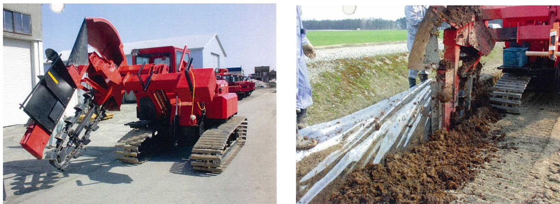
写真Ⅱ.6.11 塩ビシート埋設機器参考事例
