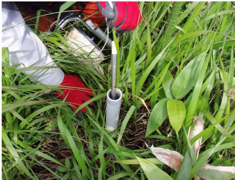
写真Ⅱ.4.7 ロープ式水位計による計測
