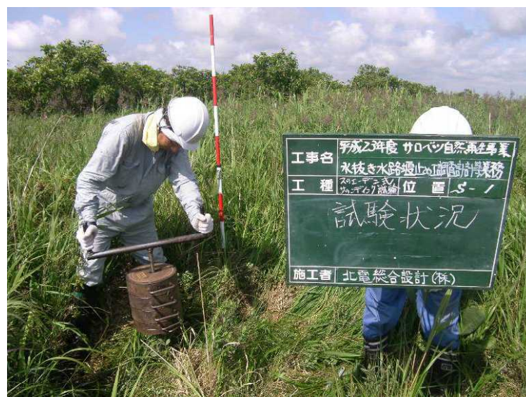
写真Ⅱ.4.1 サウンディング試験状況
