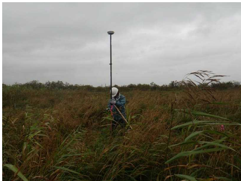
写真Ⅱ.4.5 GPS による測量（機器名：ニコン Trimble 5800Ⅱ）
