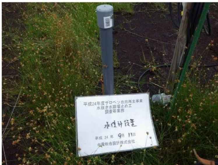
写真V. 4.2 地下水位計設置状況
