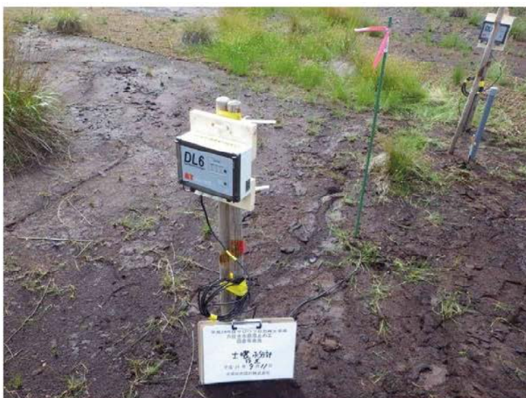
写真V. 4.3 土壌水分計設置状況
