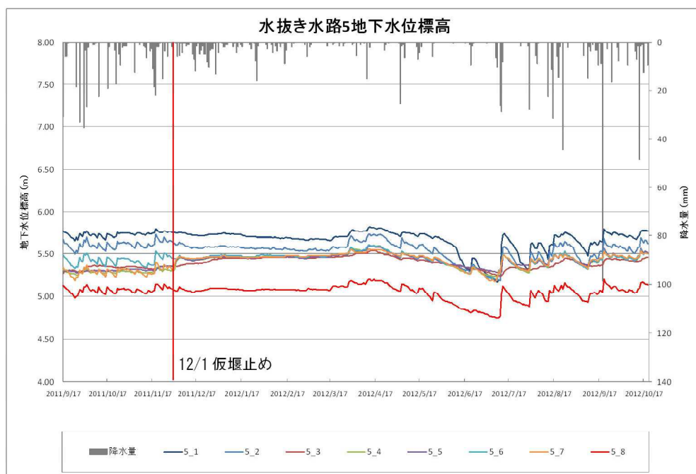
図 II. 6. 15 水抜き水路 5 の地下水位変動 (標高)
