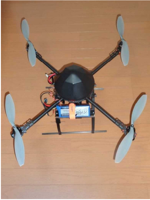
写真 4-15 調査に使用した機材 左) UAV-PH0TEC4 右) 搭載したカメラ RicohGR
