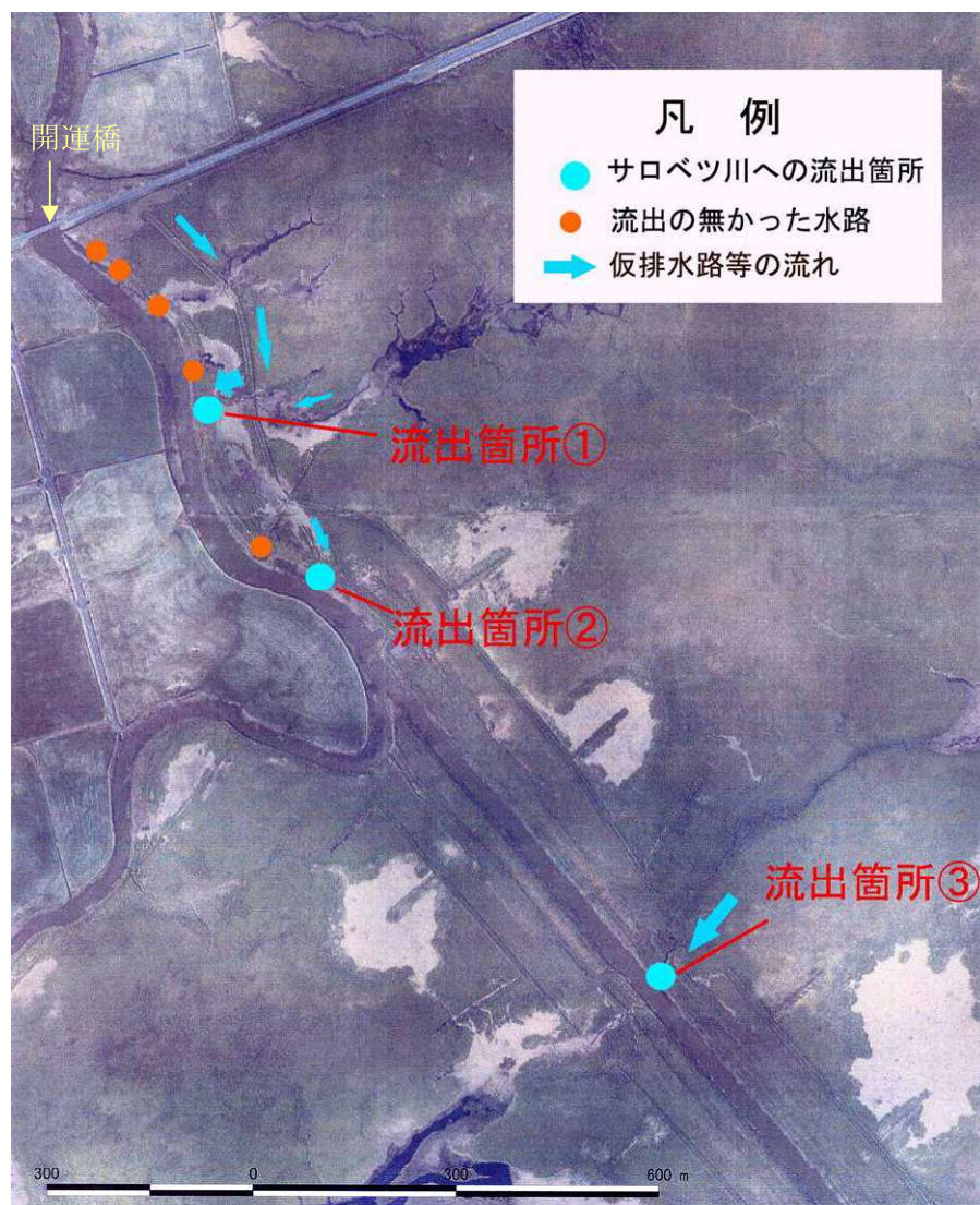
図 2.27 仮排水路等の流出箇所調査結果
