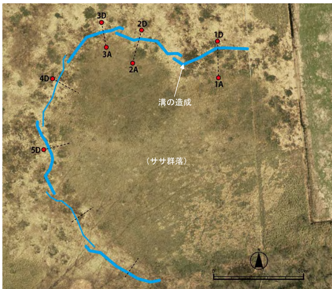
図 2-51 試験地 2（ササ群落外周部における溝造成試験地） 地下水位観測孔位置
