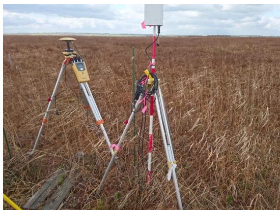
RTK 基地局設置状況
