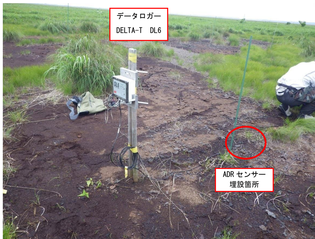
写真 5-1 土壌水分計の設置状況
