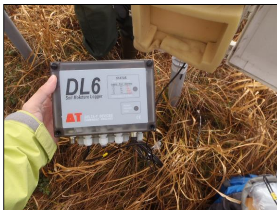
写真 5-2 S29 地点の土壌水分計の故障状況（ケーブルの断線）
