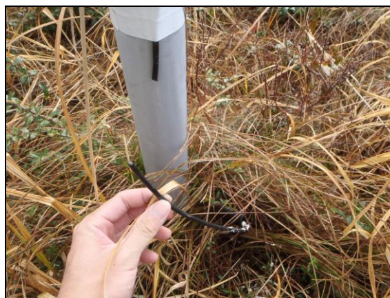
写真 5-2 S29 地点の土壌水分計の故障状況（ケーブルの断線）
