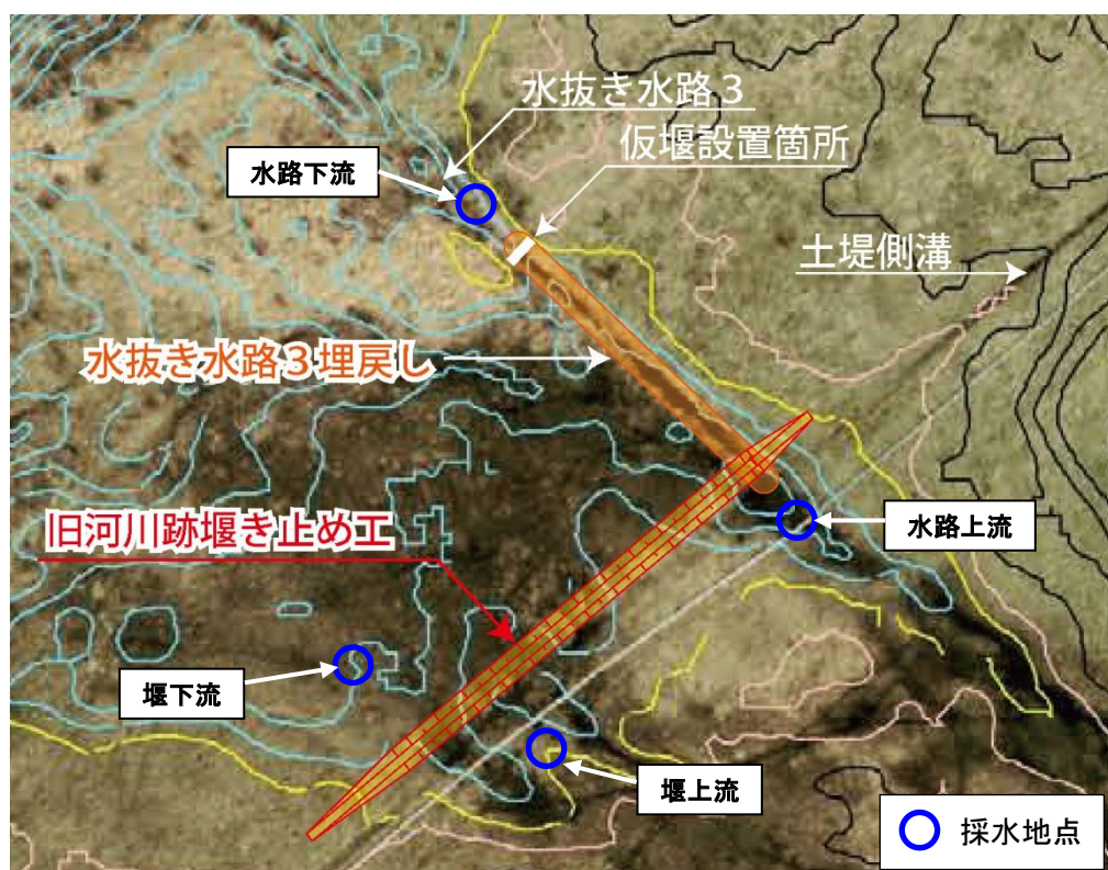
図 4-1 水抜き水路 3 及び旧河川跡採水地点
