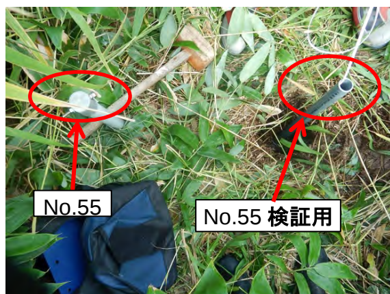
図 2-2 検証観測地下水位計設置の様子((左)水抜き水路 2、(右)旧河川跡)
