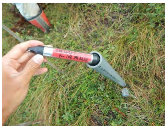
図 2-2 検証観測地下水位計設置の様子((左)水抜き水路 2、(右)旧河川跡)
