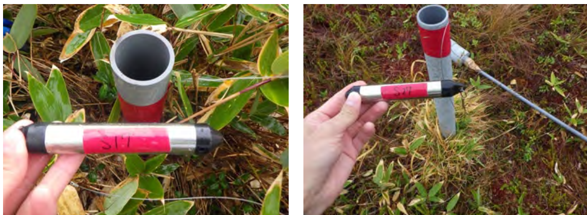
写真 2-1 地下水位計の新規設置状況（左：1-200（S17）地点、右：2-400（S27））
