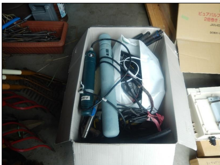
図 2-3 撤去した研究用地下水位計 (S&DL) 等
