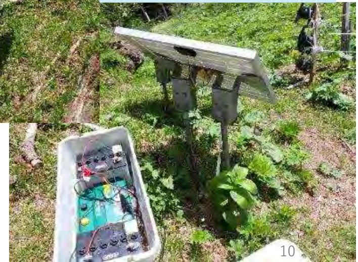
電気柵はソーラーパネルと 充電バッテリーで駆動
