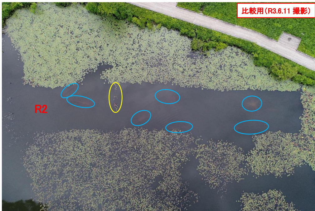
写真 2-5 R2～4敷設範囲の状況 上:R4.8.19撮影、下:R3.6.11撮影 ※青囲み:遮光シートの浮き上がり、黄囲み:接合部からのスイレン葉の生育 (黄点線:R2施工・R3施工のシート境界からと思われるスイレン葉の生育)
