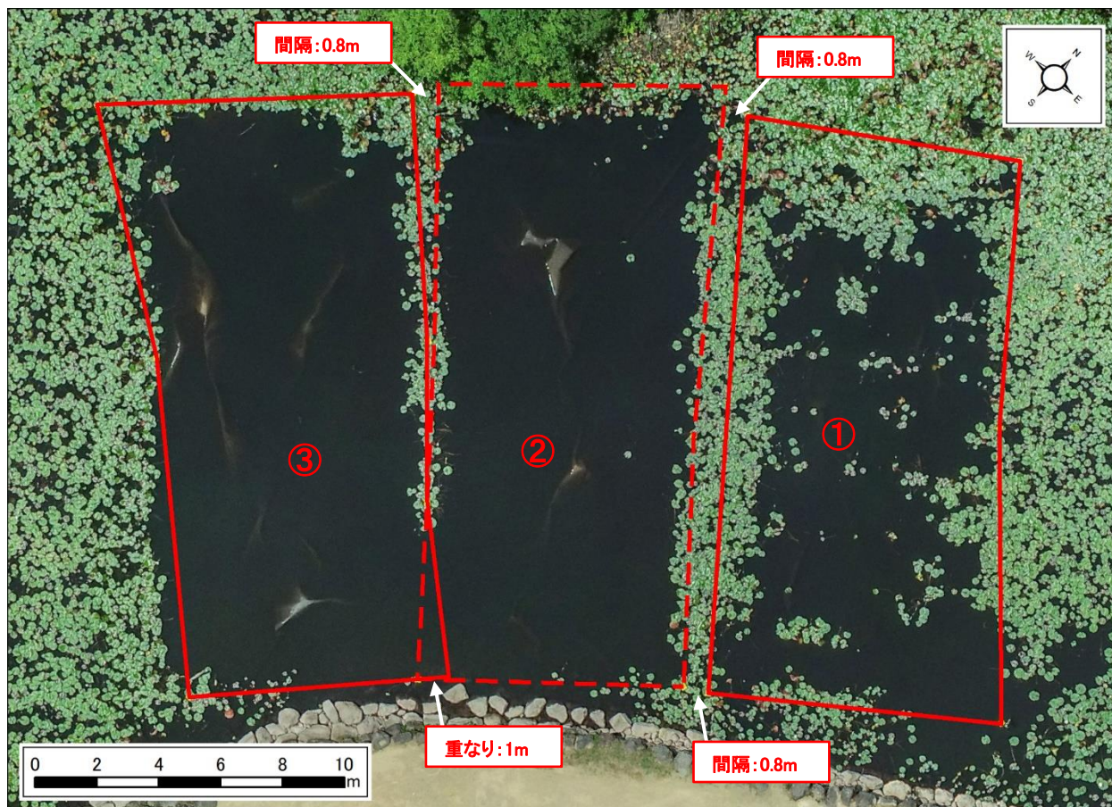
図 2-6 令和元年度の試験箇所の遮光シート敷設範囲(R4.6.28撮影)
