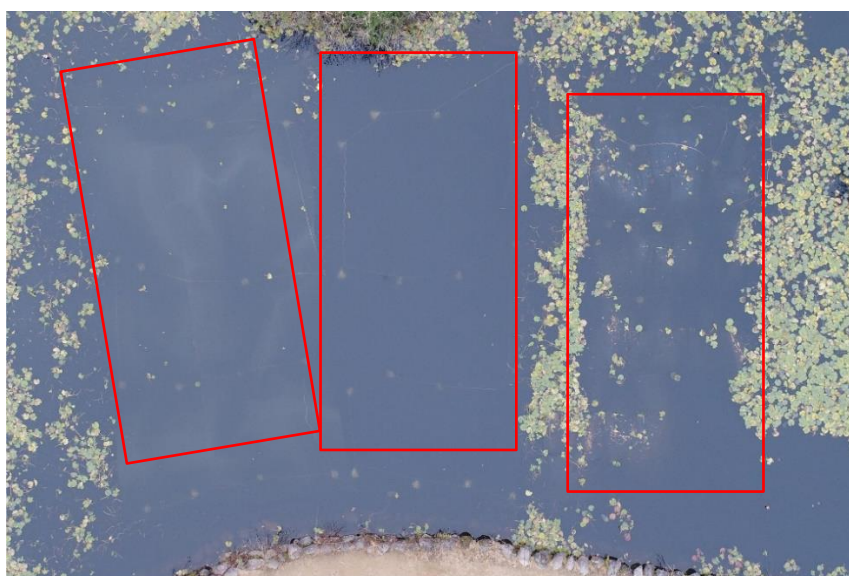
遮光シート敷設後(R1.11.21撮影) 試験範囲②③はスイレンを刈り取って敷設している。
