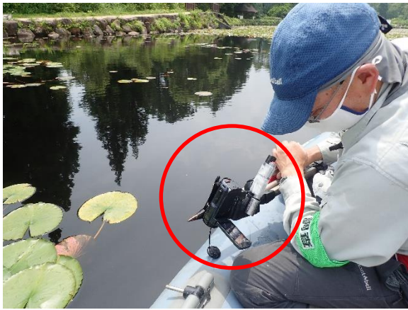
ビデオカメラと照明を取り付けた一脚を ポールに縛り付けて撮影した。
