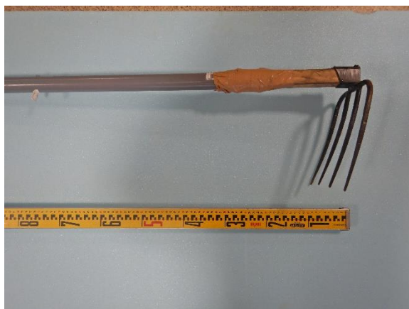
木製の柄を塩ビパイプに差し込み 柄全体で3.2mの長さとした
