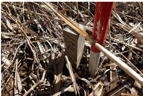
写真 3-1-1-9 木杭の例 (番号が記されている)
