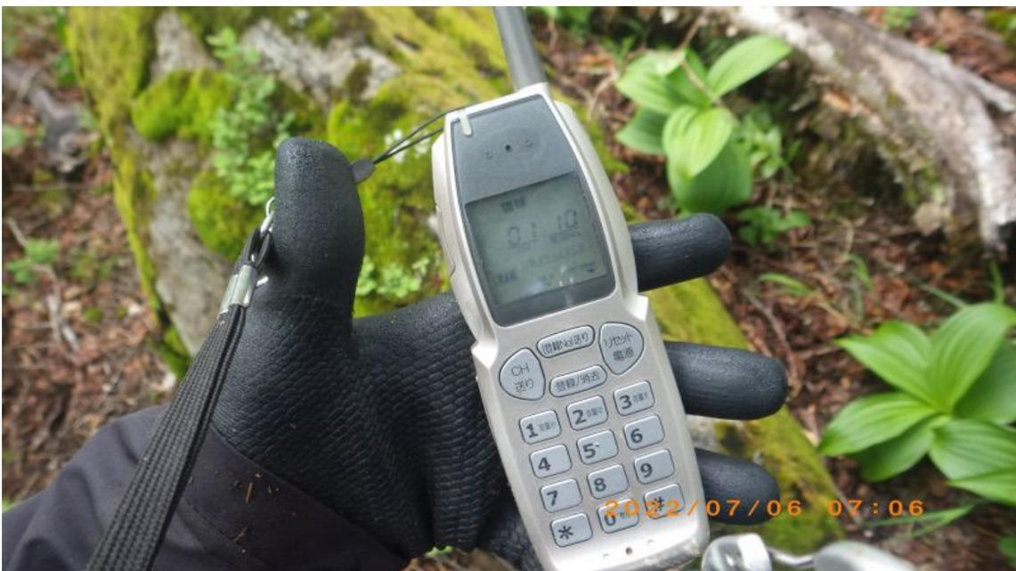
写真 II-7 簡易携帯型受信機(「竹中エンジニアリング株式会社」製、RX-50K)
