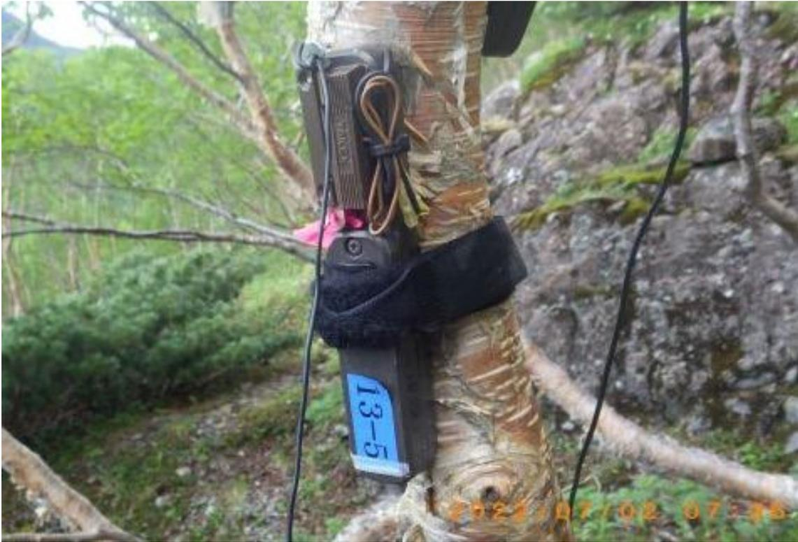
写真 II-6 送信機(「竹中エンジニアリング株式会社」製、TX-119L)
