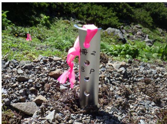
写真 IV-1 基点及び変曲点に設置したペグ
